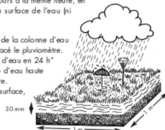
Pour faire les relevés : lire sur les graduations la quantité d'eau contenue dans le pluviomètre. Si vous utilisez des pluviomètres non étalonnés (mais tous identiques) pour comparer des quantités de pluies, vous pouvez les peser ou mesurer les hauteurs d'eau.
